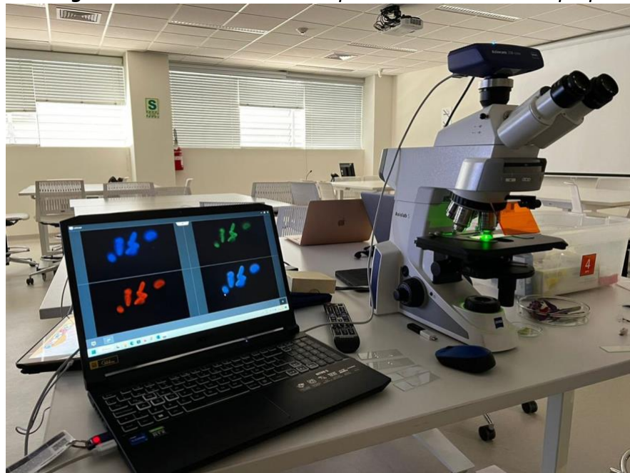
Imagen 1. Conexión del microscopio Axiolab 5 con una laptop.
